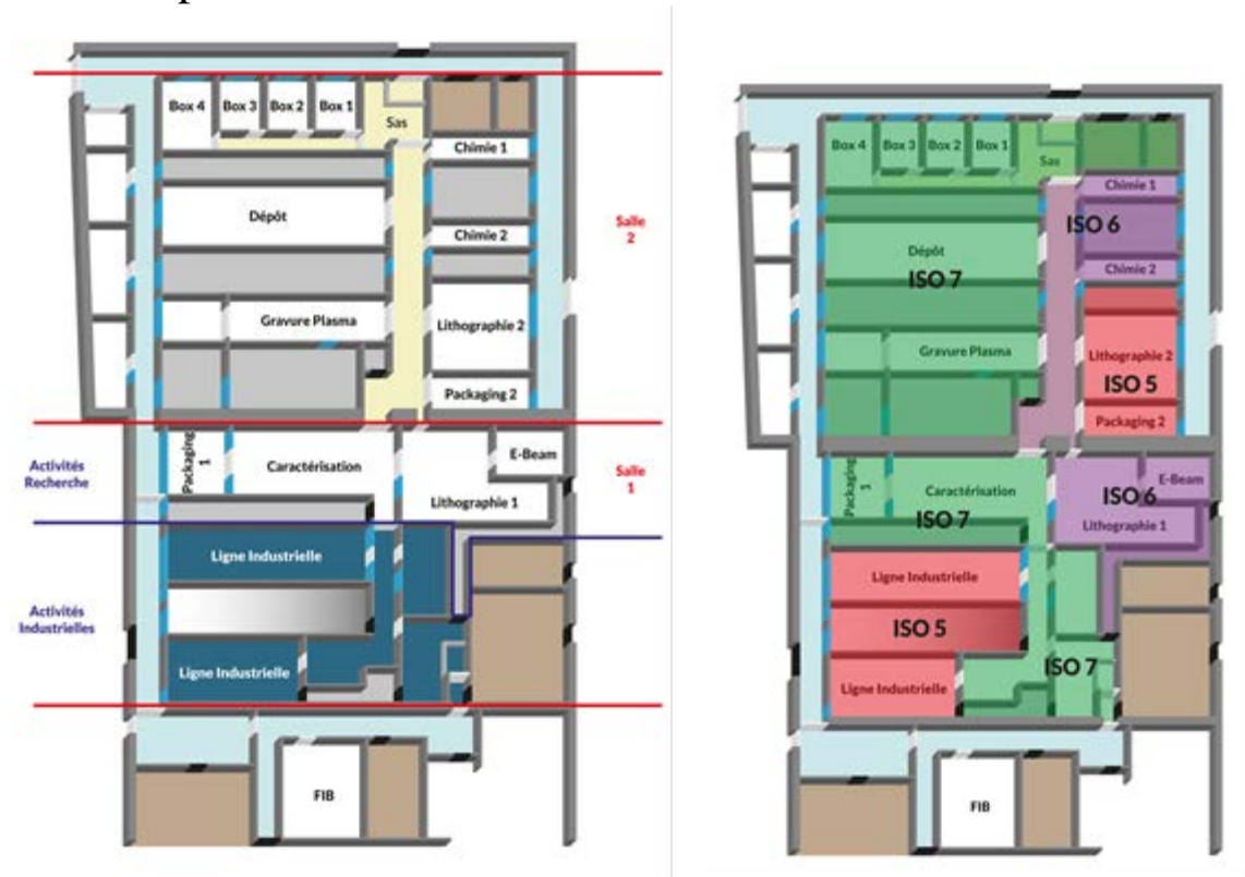
Figure 1 : Vue schématique de la salle blanche avec à gauche les salles 1 et 2 et les zones d'activités et sur la vue de droite les zones ISO
